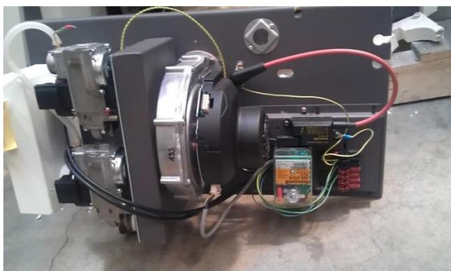
Ранее на горелки BG 2000 S 100 устанавливался блок управления с кодом **5476V016**.
